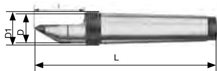
Hartmetalleinsatz, mit halber Spitze mit Abdrückgewinde Half carbide tip with thread
